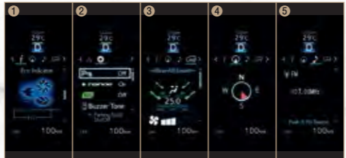
จอแสดงข้อมูลการขับขี่ MID (Multi-Information Display) 1. แสดงผลการขับขี่แบบประหยัด (ECO) 4. แสดงทิศทางพร้อมพื้นที่ 2. แสดงข้อมูลระบบทั่วไปของรถ 5. แสดงข้อมูลสัญญาณวิทยุ 3. แสดงอุณหภูมิภายในห้องโดยสาร และการทำงานของระบบปรับอากาศ
