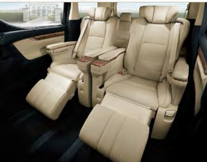
เบาะนั่งปรับไฟฟ้าแบบ Executive Lounge ตกแต่งด้วยลายไม้ และที่รองขาแบบพับได้ พร้อม Seat Ventilator และ Heater
