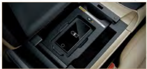
ระบบชาร์จไฟแบบไร้สาย (Wireless Charger) ชาร์จไฟได้ง่าย เพียงวางสมาร์ทโฟนบนแท่นชาร์จ และรองรับการชาร์จไฟตามมาตรฐาน Qi *เฉพาะอุปกรณ์ที่รองรับ และขนาดที่กำหนด
