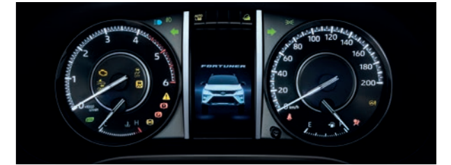
New Optitron Meter มาตรวัดเครื่องแสงพร้อมจอแสดงข้อมูล ขนาด 4.2 นิ้ว แสดงรายละเอียดการขับอย่างชัดเจน
