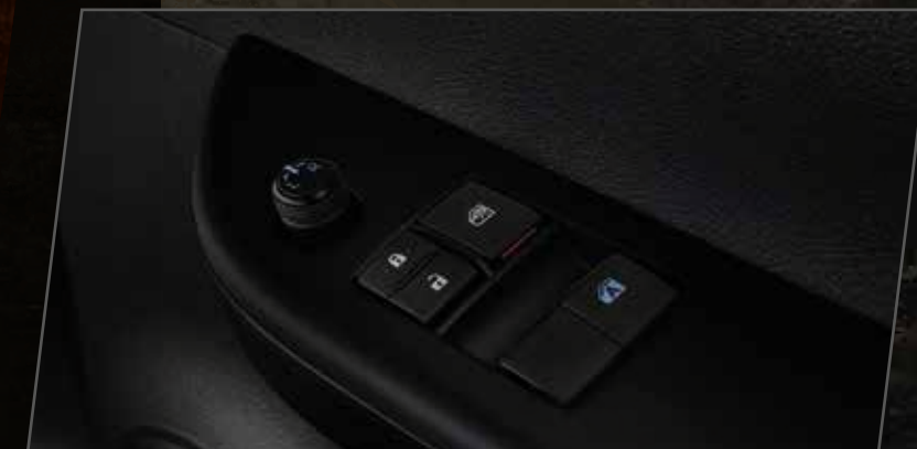
กระจกไฟฟ้า ปรับขึ้น - ลงอัตโนมัติ พร้อมระบบป้องกันการหนีบ (เฉพาะด้านคนขับ)
